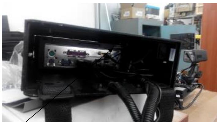
Рисунок 4 - Место пломбирования комплекса «Дозор-М», исполнение - «Дозор-М»-01
